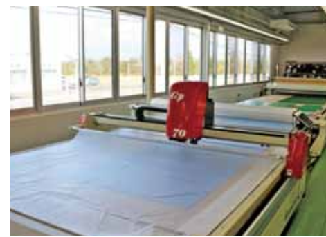
新工場にはコンピュータ制御による最新の自動裁断機を導入した
